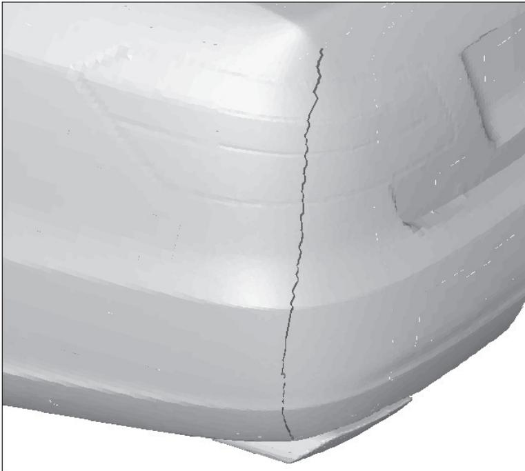
Abb. 5.9: Wenige Millimeter hohe Abrisskante am Heck des ADSMs mit Radspoiler und ohne Motorraumdurchströmung
