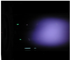
Abbildung 4.19 Flammeneigenleuchten \Delta P/P=0.4\% ; 0.6\% ; 0.8\% ; 1\% ; 2\% , \lambda=1.6 und T_{\text{vor}}=373\text{K} (Blendeinstellung f/5.6 , Belichtungszeit 1/30\text{s} )
