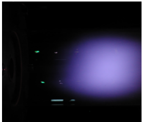
Abbildung 4.19 Flammeneigenleuchten \Delta P/P=0.4\% ; 0.6\% ; 0.8\% ; 1\% ; 2\% , \lambda=1.6 und T_{\text{vor}}=373\text{K} (Blendeinstellung f/5.6 , Belichtungszeit 1/30\text{s} )
