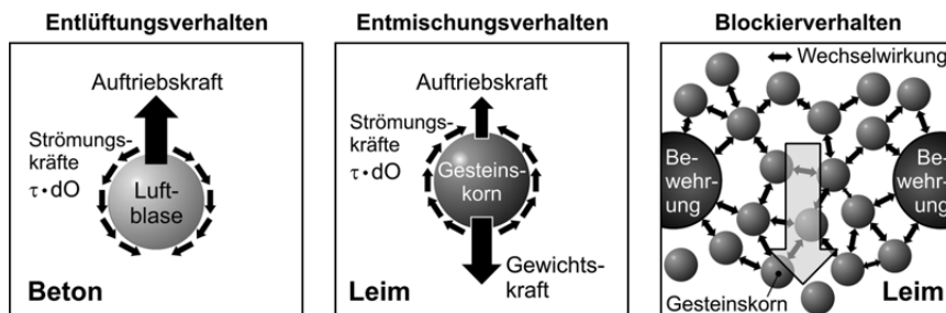
Abb. 1-1 Schematische Darstellung der Mechanismen bei der Entlüftung (links) und Entmischung (Mitte) von Beton sowie beim Blockieren der Gesteinskörnung in engen Bewehrungszwischenräumen (rechts)
