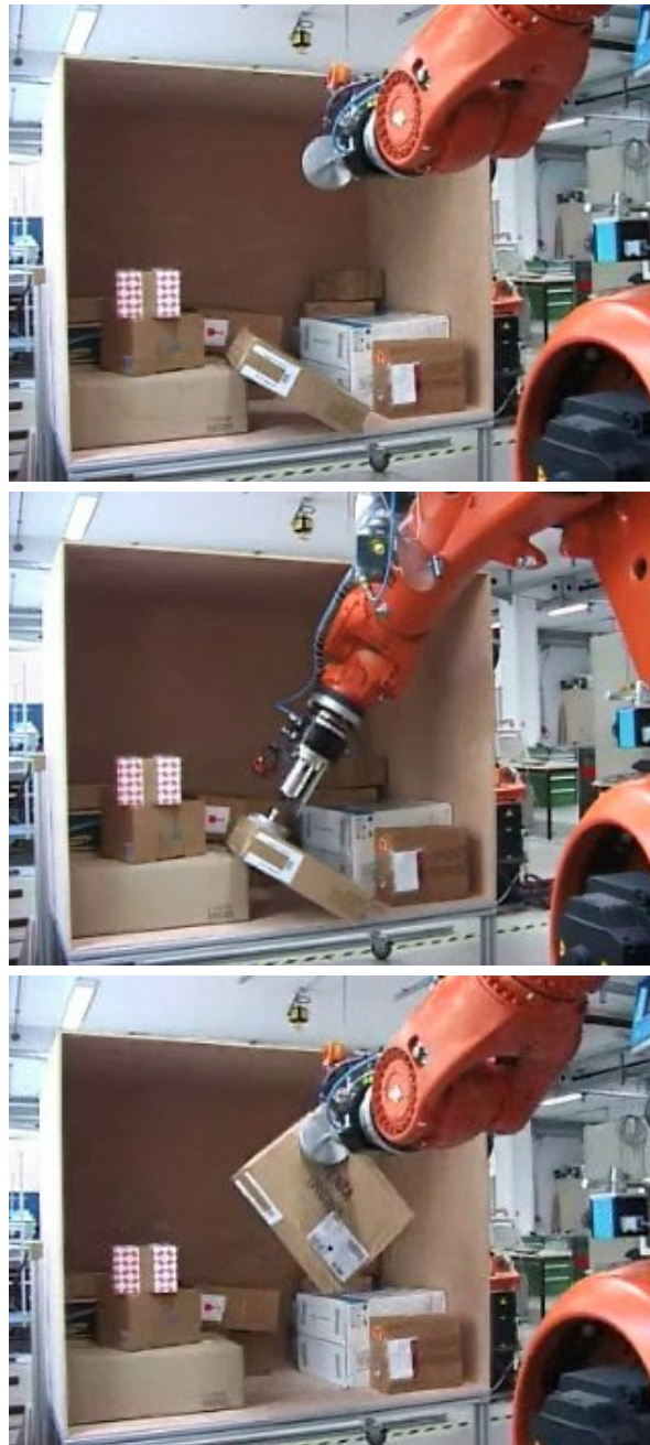
Abbildung 3.7: Entladesequenz (Bilder aus Videoaufnahme). Der Roboter bewegt sich kollisionsfrei zu der berechneten Greifposition (oben) und aktiviert den Vakuumgreifer (mitte). Anschließend verfährt der Roboter mit gegriffenem Objekt zu einer Abladeposition (unten).
