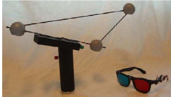
Abbildung 2.6: Dargestellt ist eine virtuelle Lackierpistole die über kugelförmige Marker getrackt werden kann. Mit Hilfe des Eingabetools können manuell Bahnen generiert werden, die dann von einem Roboter abgefahren werden können. (Foto aus [58])
