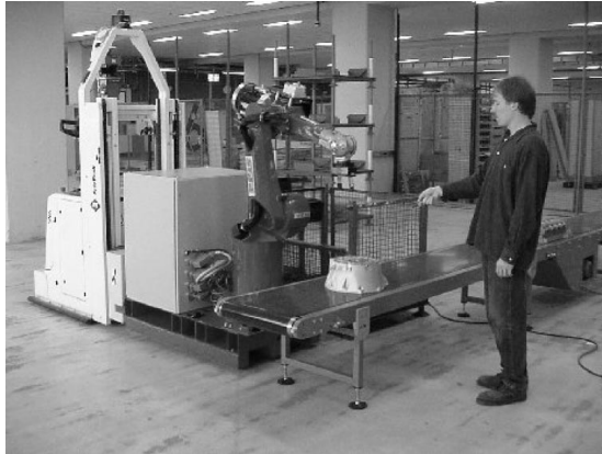
Abbildung 2.4: Der Mensch zeigt dem Roboterassistenten mit einem Laserpointer an, wo ein Werkstück auf dem Förderband abgelegt werden soll. (Foto aus [77])
