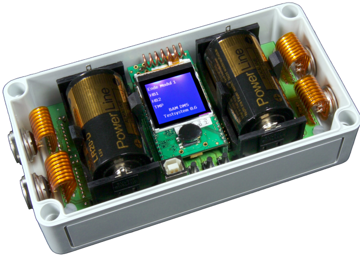
Abbildung 5.3: Modul zum Außeneinsatz, Anschluss von 8 DMS-Halbrücken möglich.
