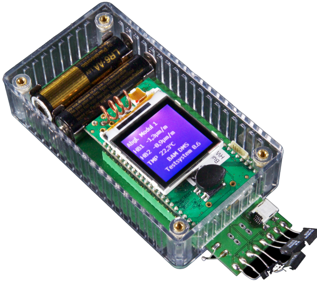
Abbildung 5.2: Innenraummodul bzw. Demonstrator zum Anschluss von 2 DMS-Halbbrücken, hier mit angelöteten Präzisionswiderständen zur Simulation von DMS.
