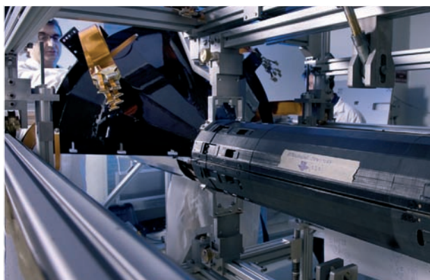
Der innere Spurdetektor des ALICE-Experiments wird integriert.
