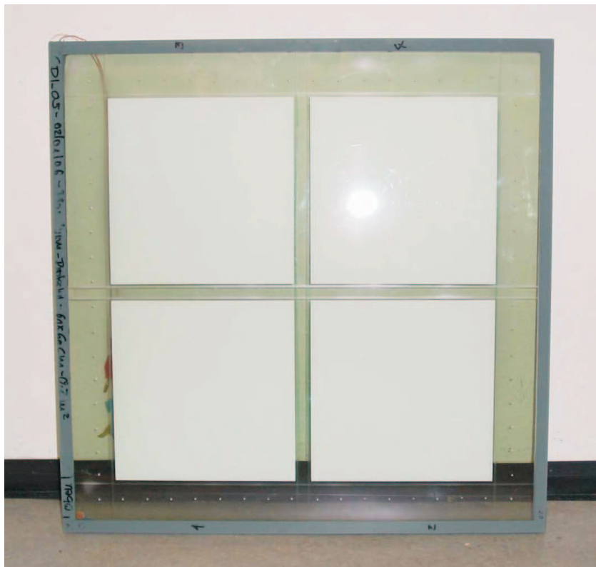
Abbildung 6.1: Planilum - DBE Lampe der Firma Saint-Gobain
