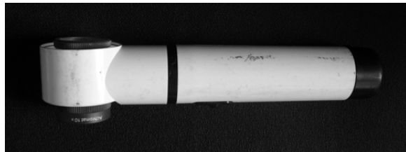
Abb. 5: Rissmesslupe mit Beleuchtungseinheit
