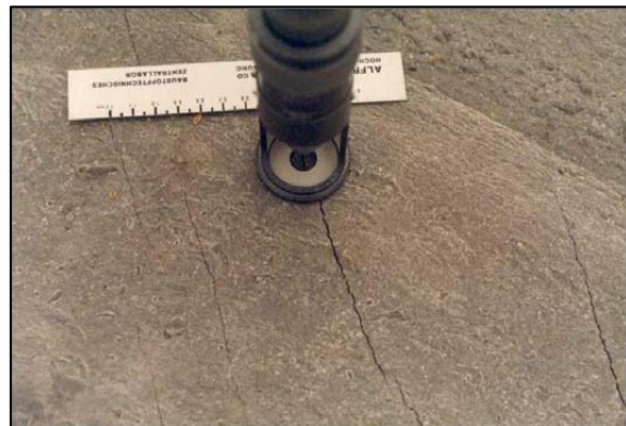
Abb. 3: Typische Frühschwindrisse in Beton
