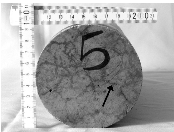
Abb. 28: Krakeleerisse sowie Riss aus grobmaschigerem Rissnetz. Beide Rissarten sind die Folge von Eigenspannungen
