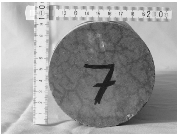
Abb. 27: Krakeleerisse infolge von Eigenspannungen
