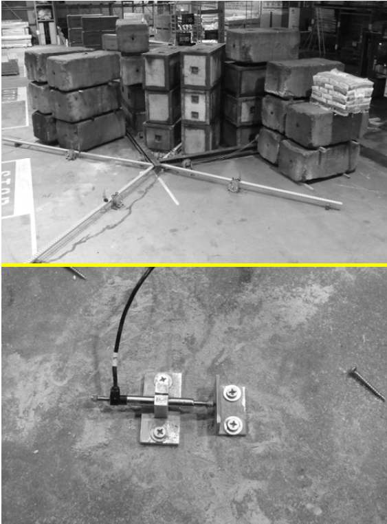
Abb. 10: Induktiver Wegaufnehmer zur Bestimmung von Rissbreitenänderungen (verdämmter Riss) während eines Belastungsversuches einer Bodenplatte
