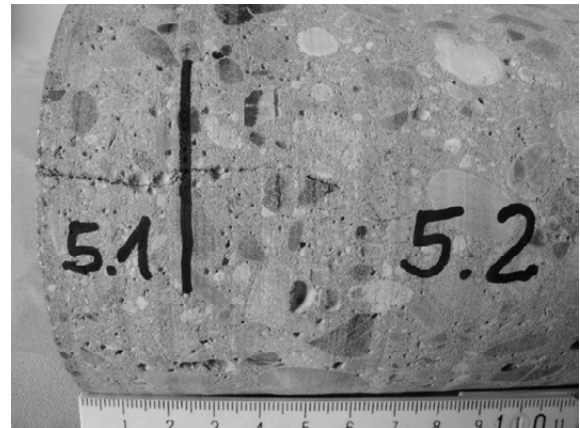
Abb. 29: Ermittlung der Tiefe von Rissen infolge Eigenspannungen
