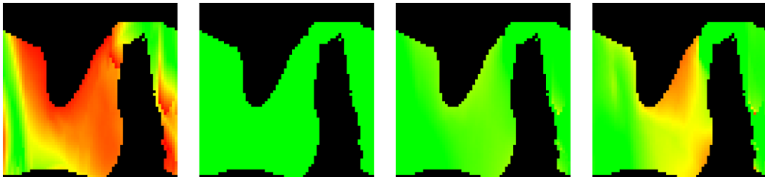
Abbildung 5.44: Ortsaufgelöste Karten zu verschiedenen statistischen Aspekten der Radien der Kavitäten (vlnr): Minimaler Radius, maximaler Radius, mittlerer Radius, Median des Radius. Die Werte können nach dem Ampel-Prinzip anhand vorgegebener Grenzwerte farblich kodiert dargestellt werden.
