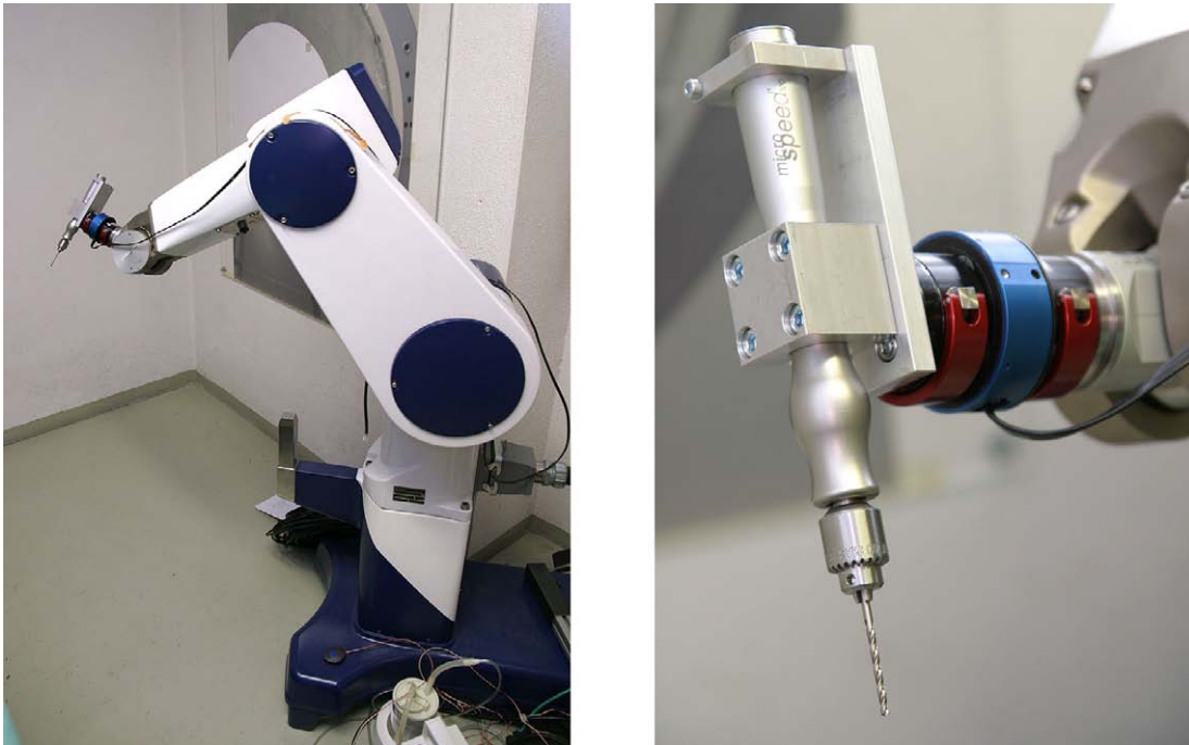
Abbildung 7.1: Robotersystem zum präzisen Anlegen linearer Bohrkanäle. Auf der linken Seite ist der RX-90 Roboter mit angeflanschem Bohrkopf zu sehen. Die rechte Seite zeigt den Bohrkopf in einer Vergrößerung. Zu sehen ist der Kraft-Momenten-Sensor zwischen Roboter und Bohrkopf.
