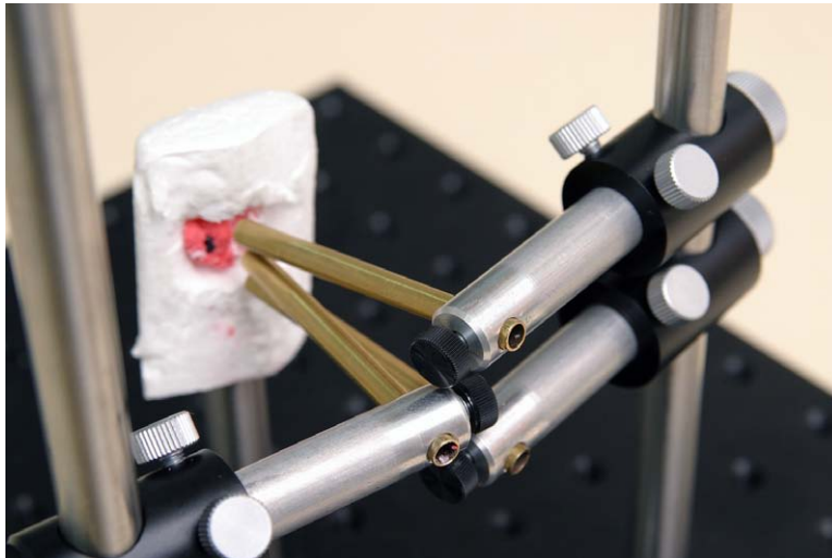
Abbildung 7.5: Schulungssystem zur Simulation ähnlicher Bedingungen, wie sie in der Minimal Traumatischen Chirurgie vorzufinden sein werden. Die Bohrkanäle werden durch drei frei arrangierbare Rohre nachgebildet.
