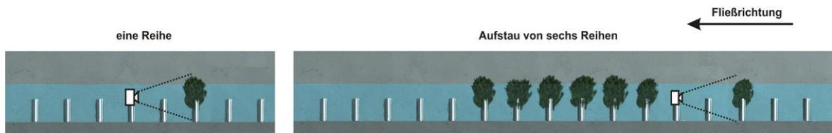
Abb. 42: Position der Kamera bei den Fotoaufnahmen unter Wasser: links: eine Reihe, rechts: Auswirkungen des Aufstaus von sechs Reihen auf die Flächenkontraktion.
