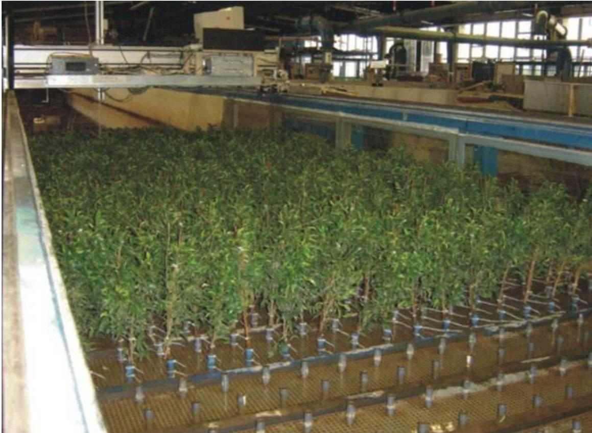
Abb. 35: Einbau der belaubten Weidenzweige mit einer Besatzdichte von 100 % in der „Großen Rinne“ (BAUMEISTER 2007)
