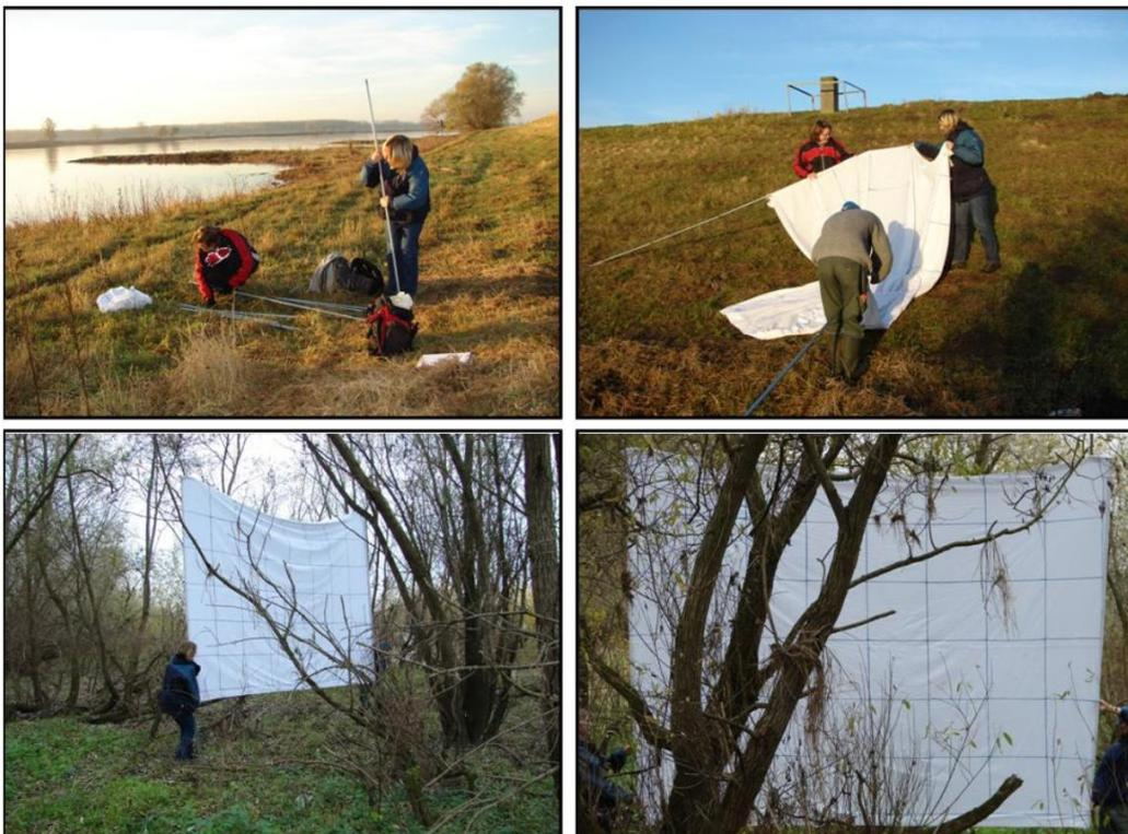
Abb. 38: Aufbau des Messrahmens: links oben: Verschrauben des Messrahmens, rechts oben: Aufziehen des Rasters, links unten: Transport des Rahmens im Gelände, rechts unten: Aufstellen des Rahmens hinter der Vegetation.
