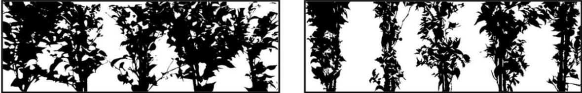
Abb. 47: Veränderung der hydraulisch wirksamen Vegetationsfläche in Abhängigkeit der Fließgeschwindigkeit: links: 6xxxxx\_E3\_40, rechts: xxxxx\_E3\_40; beide Bilder wurden im durchströmten Fall aufgenommen.
