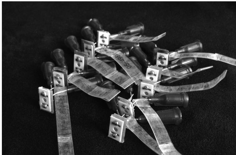
**Abbildung 6.7:** Fotografie der mittels Serienfertigung hergestellten Ventile.
