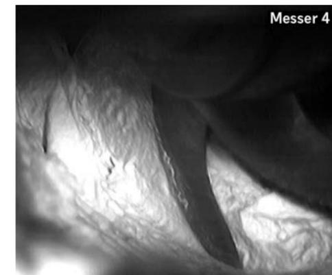
**Abb. 2** → Das vierte Messer bewegt sich durch den tiefsten Punkt der Schüssel und dreht leer. Bereits während das zweite und das dritte Messer durch die Schüssel drehen, bewegt sich das abgetrennte Segment außerhalb von deren Zerkleinerungsbereich und wird während des Durchtritts des vierten Messers an der Schüssel abgelegt. Die Schüssel dreht so langsam, dass das fünfte und das sechste Messer kein Segment abschneiden können. (Drehgeschwindigkeit 4000 UpM).
