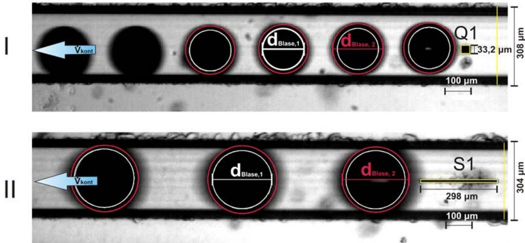
Abb. 6.2.: (I) Die quadratische Düse Q1 bei den Parametern  $\dot{V}_{disp} = 18 \text{ ml/h}$  und  $\dot{V}_{kont} = 50 \text{ ml/h}$ . Der Blasendurchmesser  $d_{Blase,1} = 162,4 \mu\text{m}$ , welcher aus der Frequenz berechnet wurde, ist kleiner als der manuell eingezeichnete Blasendurchmesser  $d_{Blase,2} = 193,9 \mu\text{m}$ . Die bereits vermessenen Referenzlängen (Düsenmaß=33,2  $\mu\text{m}$ , Kanalbreite 308  $\mu\text{m}$ ) sind gelb gekennzeichnet.
