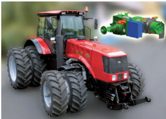
Diesel-elektrischer Traktor Belarus 3023 mit bis zu 172 kW elektrischer Leistung für Anbaugeräte
