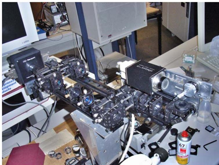
Abbildung 5.56: Interferenz mit zwei verschiedenen Teilstrahlen (im rechten Strahlengang fehlen im Bild Pinhole und zweite Linse)
