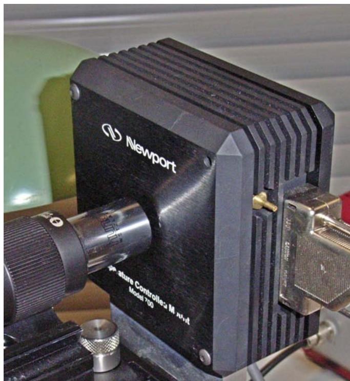
**Abbildung 5.46:** Fassung des Diodencontrollers, Diode von Mikroskopobjektiv verdeckt
