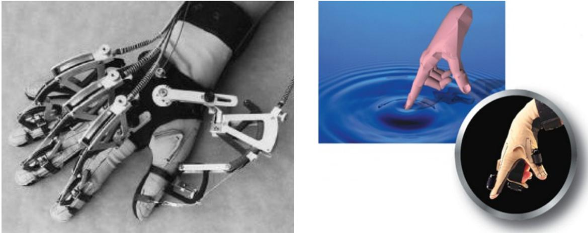
**FIGURE 39: THE CYBERGRASP® (LEFT) AND CYBERTOUCH® (RIGHT) FROM IMMERSION.**
