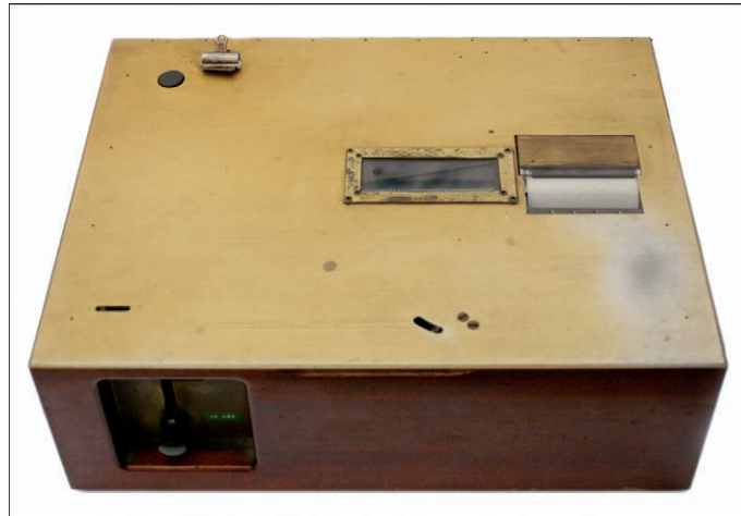
Abbildung 2.20: Lehrmaschine nach B.F. Skinner (Quelle: [Fie08]). Die Lehrmaschine besteht im Wesentlichen aus einem kleinen Kasten, auf dessen Oberseite ein Fenster angebracht ist. In diesem Fenster ist ein Papierstreifen sichtbar, der z. B. eine Gleichung mit einer fehlenden Ziffer enthält. Dort, wo die Ziffer fehlt, ist ein Loch in den Streifen gestanzt. Durch Bewegen eines Schiebers kann der Lernende eine richtige Ziffer auswählen und in dem Loch platzieren. Anschließend wird zur Bestätigung der Auswahl ein Hebel gedrückt. Ist die Antwort richtig, lässt sich der Hebel drehen, es ertönt ein Glockenton (konditionierte Verstärkung) und die nächste Frage wird dargeboten. Ist die Antwort hingegen falsch, lässt sich der Hebel nicht bewegen, und es muss erneut versucht werden, die richtige Antwort zu geben.
