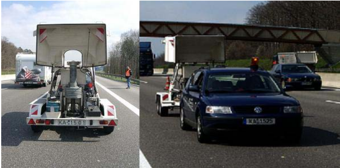
Abb. B.1: FWD mit Zugfahrzeug im Messbetrieb
