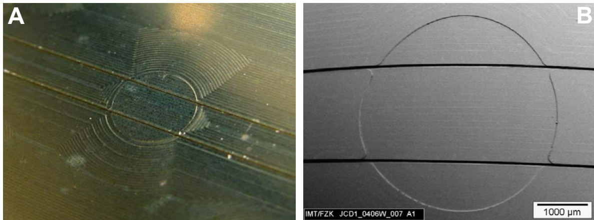
Abb. 4-10 A: Erhabene Taschenform mit einem Durchmesser von 4 mm und einer Höhe von 5 µm auf dem Formeinsetz aus Messing; B: In PC abgeformte Membrantasche durch zwei Separationskanäle
