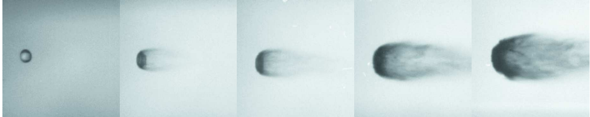
Abbildung 2.6: Tropfenzerstörung bei We_0 = 11700 (Joseph et al. 1999)
