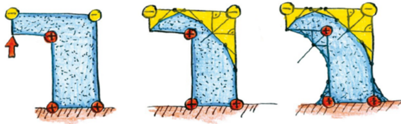
Abbildung 3.8: Kerbformoptimierung und Leichtbau mit der Methode der Zugdreiecke [26]
