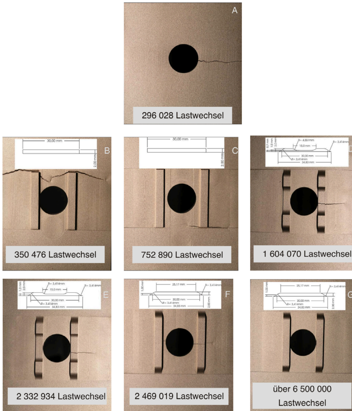
Abbildung 5.12: Beispiele versagter Messingproben (MS58) nach schwingender Belastung (zugschwellend). Versuch: Dr. K. Bethge
