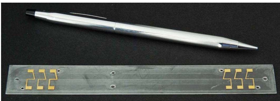
Abb. 3-15 Abgeformter und thermisch gebondeter PS-Chip für die bidirektionale CE mit gesputterten C^4D -Messelektroden.
