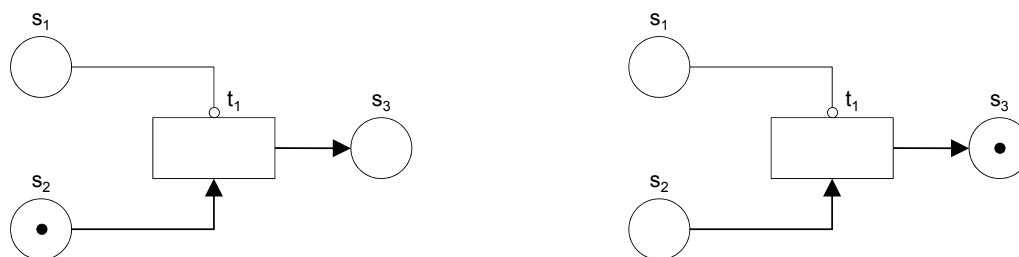
Abbildung 92: Schaltvorgang mit Verbotskante
