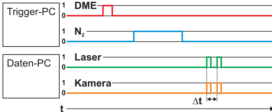
Abbildung 6.9.: Synchronisation der Ventile für das Schattenverfahren. Die Tropfen strömen ohne Trägerströmung in die Kammer ein. Erst nach erfolgter Zündung strömt der Stickstoff zum Ausschieben des verbliebenen Brennstoffes in die Kammer ein. Der Laser und die Kamera lösen je zweimal aus. Aus dem Doppelbild wird die Tropfengeschwindigkeit berechnet.
