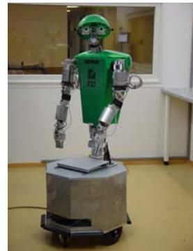
**Abb. 5.2.:** Die Vorläufer von *ARMAR-III*: *ARMAR-I* (links), *ARMAR-I* mit modifizierter Tragstruktur im Oberkörper und Verkleidung (in der Mitte), *ARMAR-II* mit verbessertem Rechner-system und Verkleidung (rechts)
