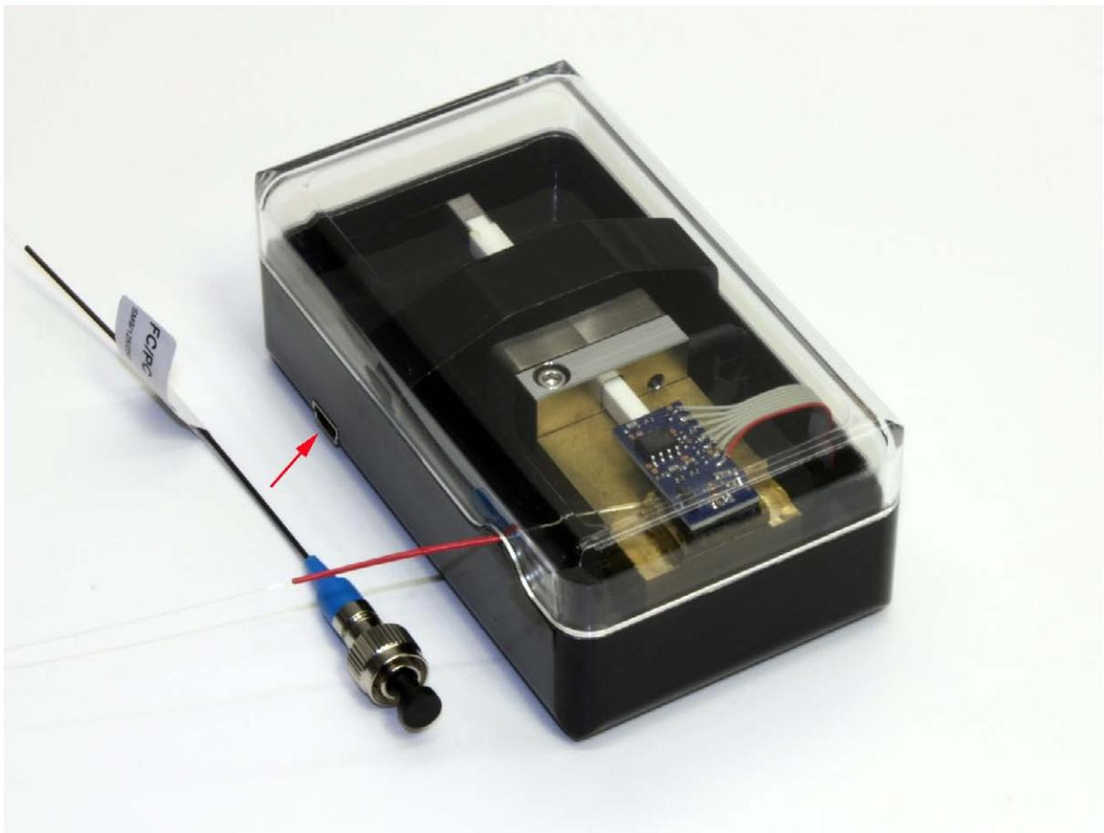
Abbildung 6.16: Prototyp mit Inchwormaktor und elektronischer Singalausgabe. Die Abmessungen des Gesamtsystems betragen 95 mm x 55 mm x 37,5 mm.
