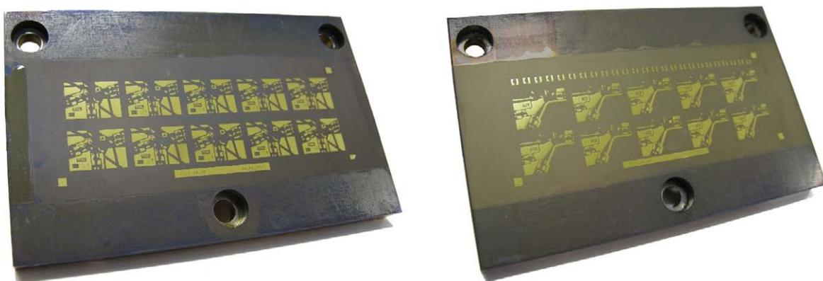
Abbildung 6.2: LIGA-Arbeitsmasken für das LIGA-Interferometer mit Glaskomponenten (links) und das LIGA-Interferometer basierend auf Totalreflektion (rechts).
