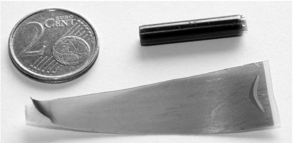
**Abb. 4.32:** Eine fertige Rolllinse mit einer Länge von etwa 20 mm, der Durchmesser des optisch aktiven Teils beträgt  $980\ \mu\text{m}$ ; unten im Bild eine zugeschnittene strukturierte Folie zum Wickeln einer Rolllinse
