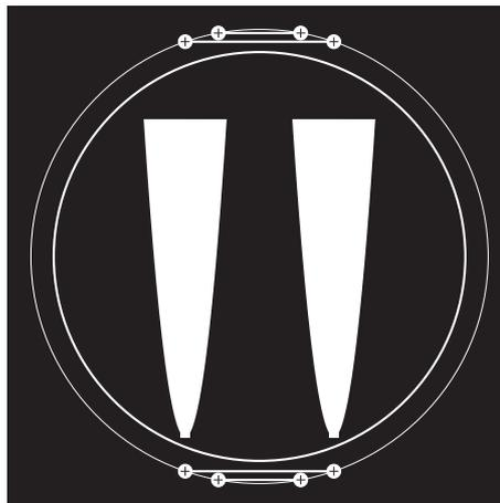
**Abb. 4.25:** Zeichnung der Folienmaske zur Erzeugung der annähernd parabelförmigen Gestalt der strukturierten Folie, zur Nutzung mit Negativresist; zur Ausrichtung zu den Waferflats sind Justiermarken vorhanden
