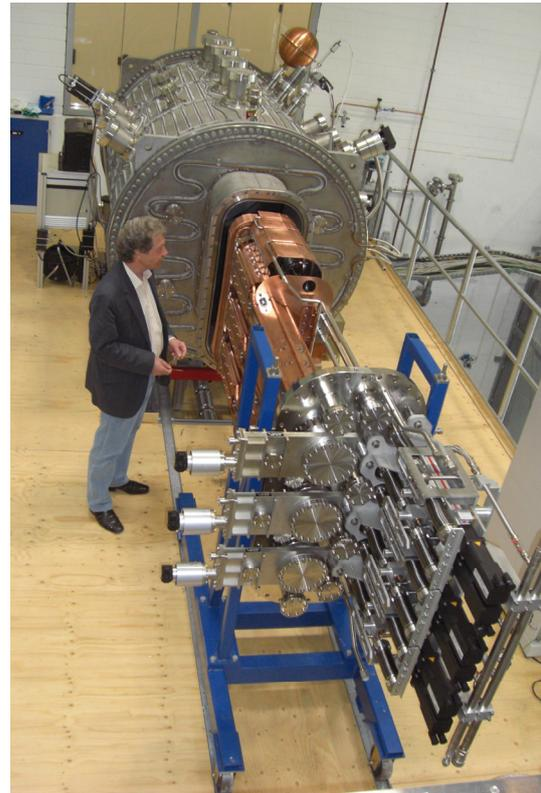
Test einer Einstrahlantenne (Launcher) in der MISTRAL Vakuum-Test-Kammer am IPP Greifswald.
