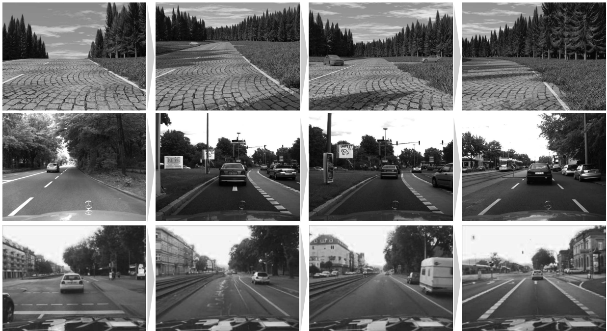
Abbildung 5.1: Momentaufnahmen einiger in dieser Arbeit verwendeten Stereosequenzen. Die realen Bilddaten wurden mit den Versuchsträgern des Instituts für Mess- und Regelungstechnik (MRT) aufgenommen. Hierfür liegen größtenteils die Informationen der Eigenfahrzeugdynamik in Form von IMU/GPS-Daten vor. Diese wurden u. a. bei der Auswertung der Güte der Bewegungsschätzung verwendet.
