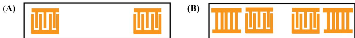
**Abb. 1-3: Schematische Anordnung der IDT-Strukturen bei einer Verzögerungsleitung/ Delayline (A) und einem Resonator (B).**
