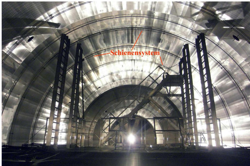
**Abbildung 2.13:** Blick in den Hauptspektrometertank von KATRIN. Aktuell wird das Innere Elektrodensystem auf einem Schienensystem installiert. Die Montage erfolgt unter Zuhilfenahme des im Bild zu sehenden Gerüsts.
