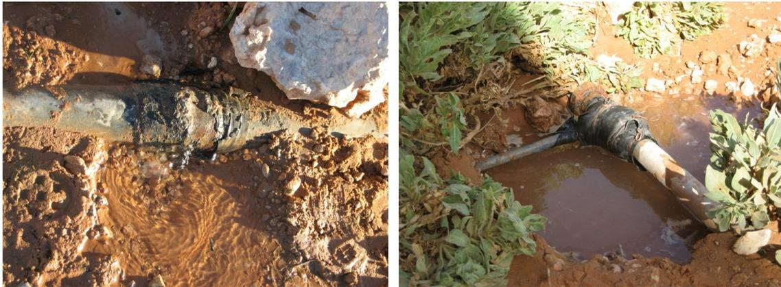
Abbildung 4.5: Leckagen und deren unsachgemäße Reparatur
