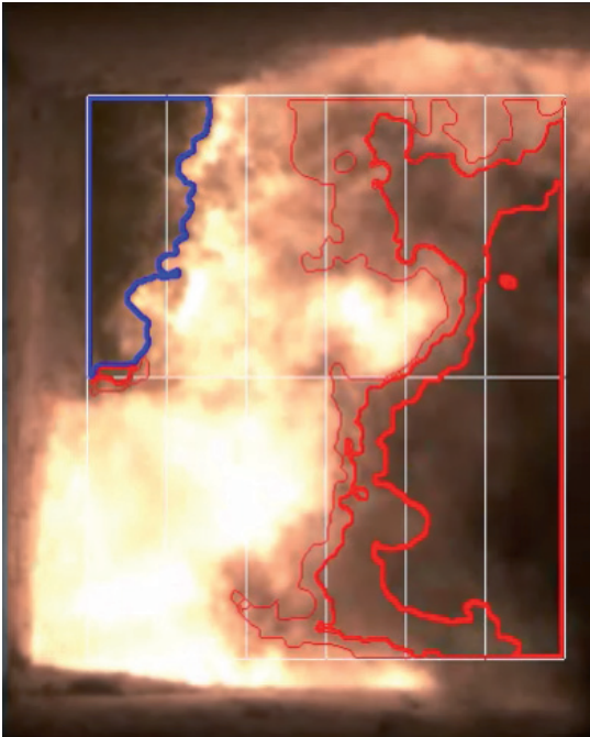
Abb. 4: Ruß-Rost-Klassifikation Abgasausbrandzone (bewegungsbasierte Segmentierung) Integration in das INSPECT-System
