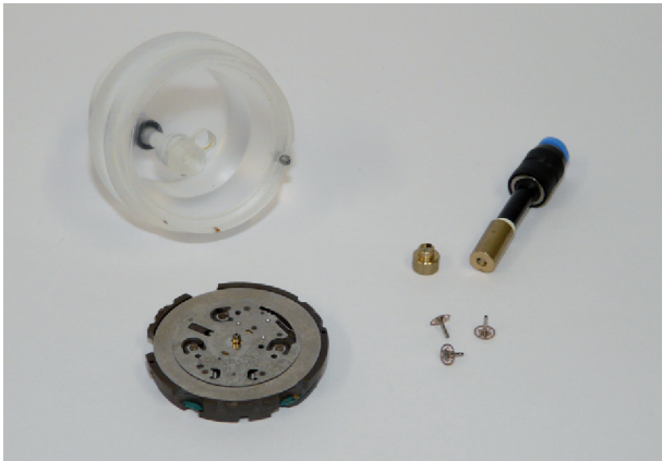
Abb. 36: Greiferprototypen zum Greifen unterschiedlicher Bauteile des Teilespektrums
