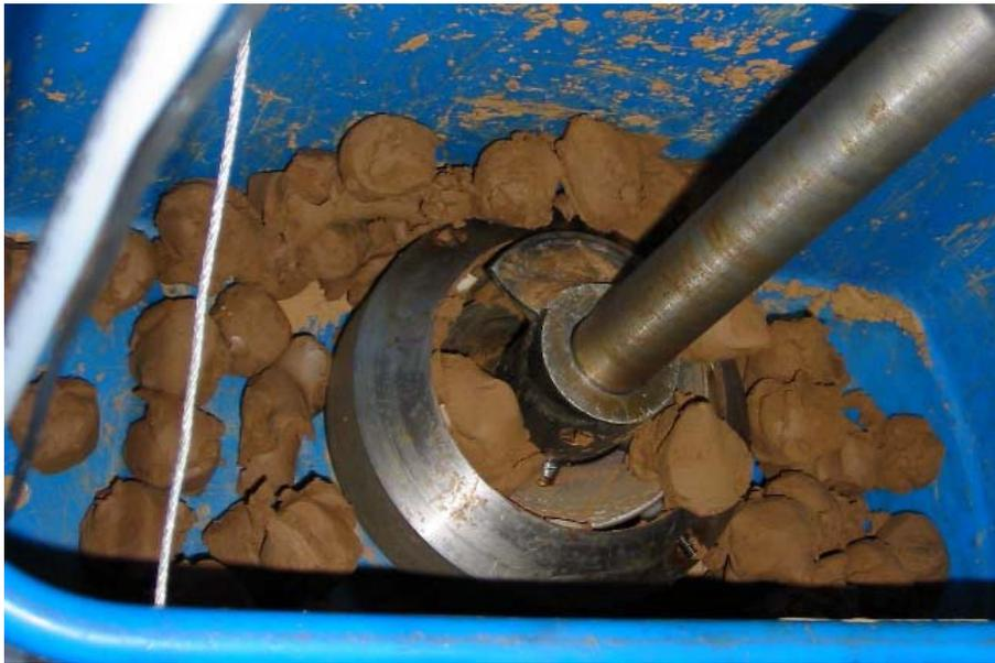
**Abb. 7.17:** Unterschiedliche Förderarten bei Versuchen mit dem MRV Kombination M2, Versuch 079,  $w = 24\%$  → Rollkörperförderung
