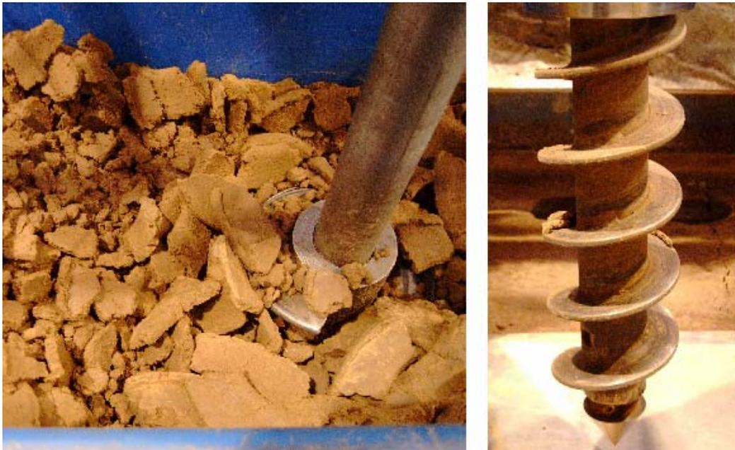
**Abb. 7.15:** Erdstoffkörper und leergeförderte Schnecke nach Versuch mit Luftspülung (Versuch 110, Kombination M2,  $w = 18\%$ )
