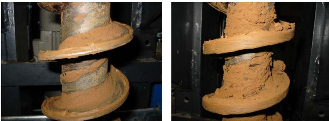
**Abb. 7.19:** Bohrschnecke nach dem Versuch mit elektrischer Gleichspannung: links, als Kathode (Regelfall), rechts als Anode („verpolt“)
