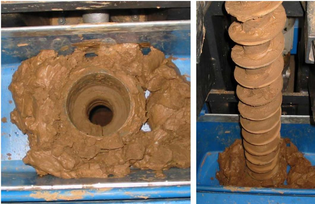
**Abb. 7.13:** Versuchsabbruch wegen Überlastung des Versuchsstandes beim Bohren mit Wasserzugabe im Originalboden (Kombination F2,  $w = 15\%$ )
