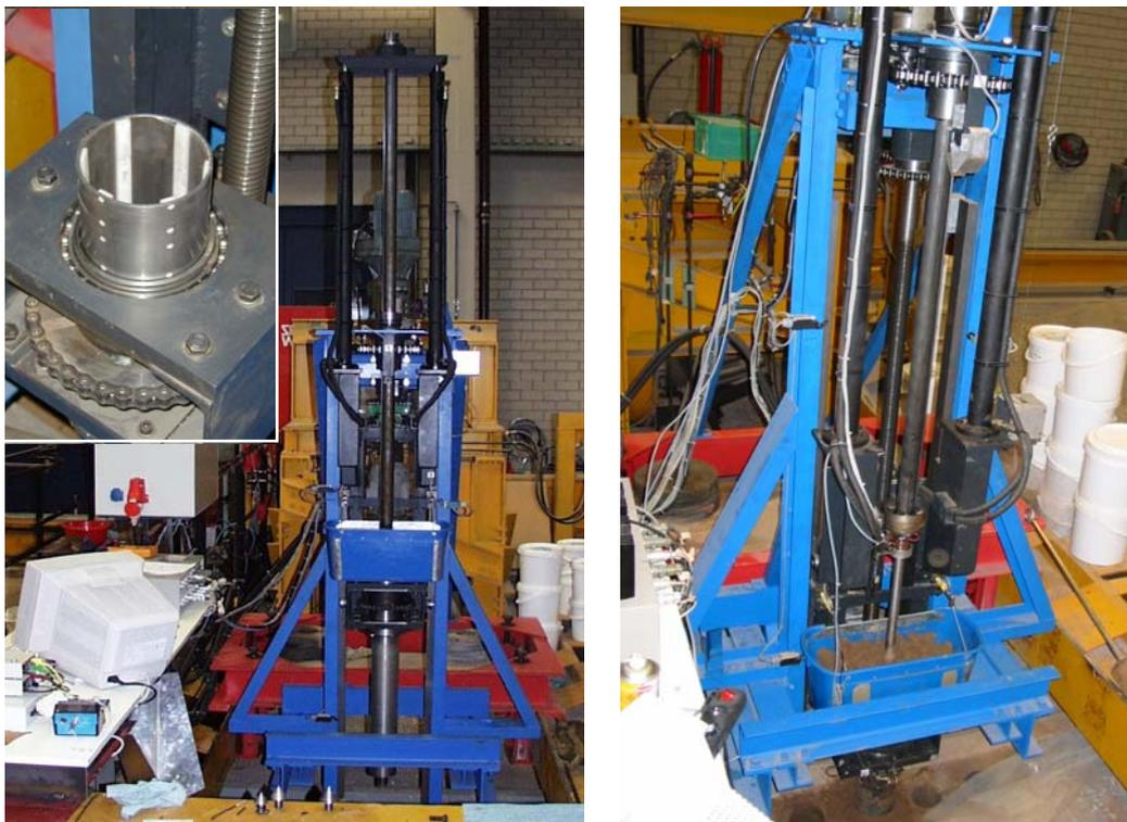
**Abb. 5.4:** Versuchsstand zur Untersuchung des Erdstoff-Förderverhaltens beim BoSiM
