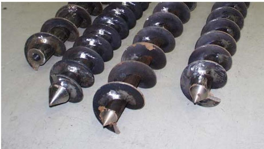
**Abb. 7.1:** Bohrschnecken 1 bis 4 mit Schraubspitzen (von links nach rechts)
