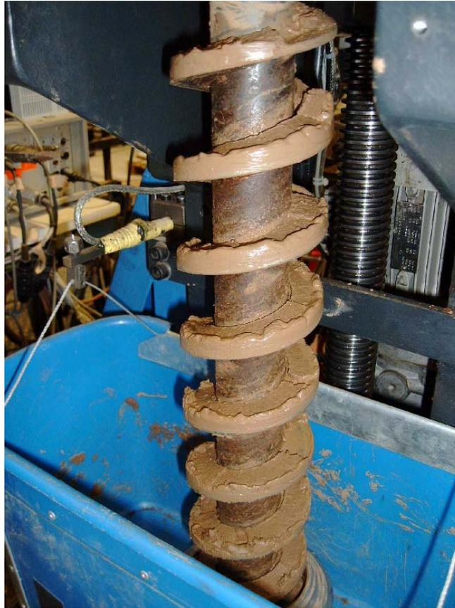
**Abb. 7.14:** Erdstoffkörper nach Versuch mit Wasserzugabe
