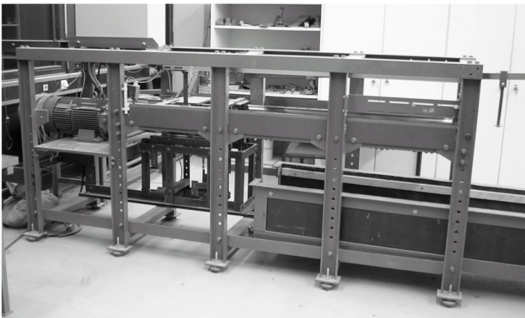
**Abb. 5.1:** Die verwendete Scherrinne mit frei aufgehängtem großem Scherrahmen
