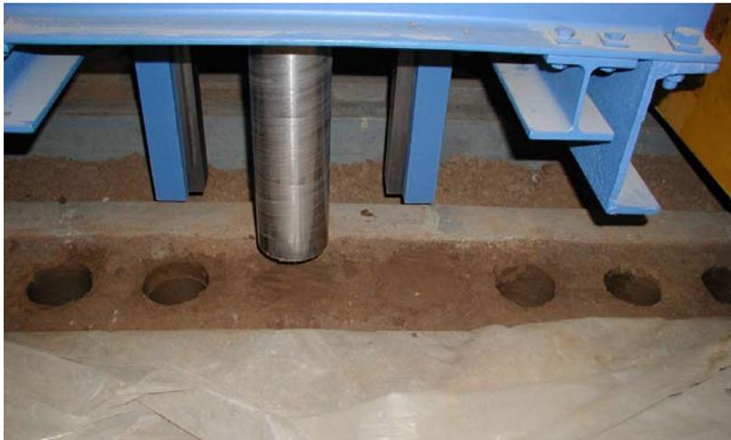
**Abb. 5.13:** Boden in der Rinne mit zwei wiederverfüllten Bohrungen
