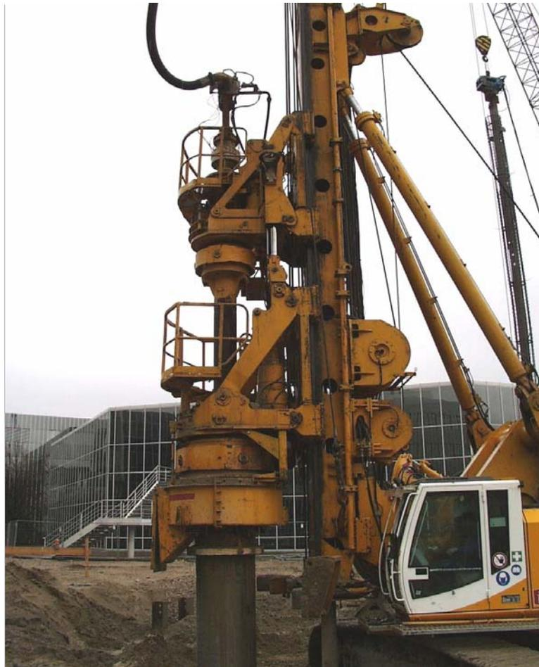
**Abb. 2.2:** Bohrgerät für das BolSiM mit zwei Kraftdrehköpfen am Mäkler
