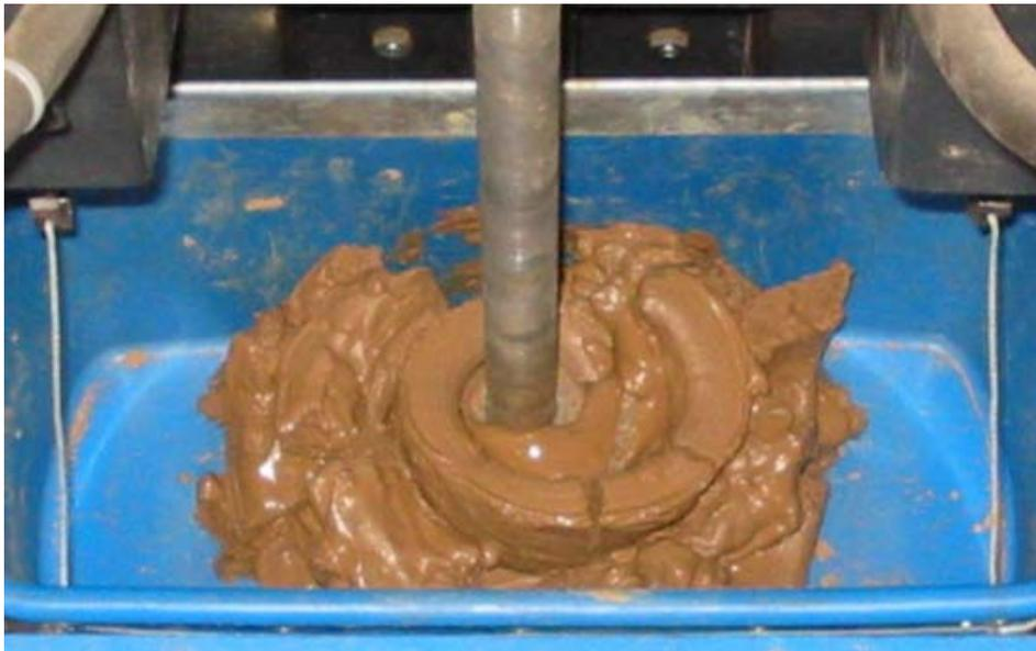
**Abb. 7.12:** Erdstoffaustrag beim Bohren mit Wasserzugabe im Originalboden
