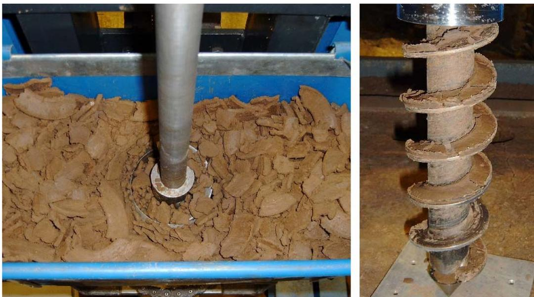
**Abb. 7.8:** Erdstoffkörper nach dem Versuch (Versuch 109, Kombination M2,  $w = 18\%$ )
