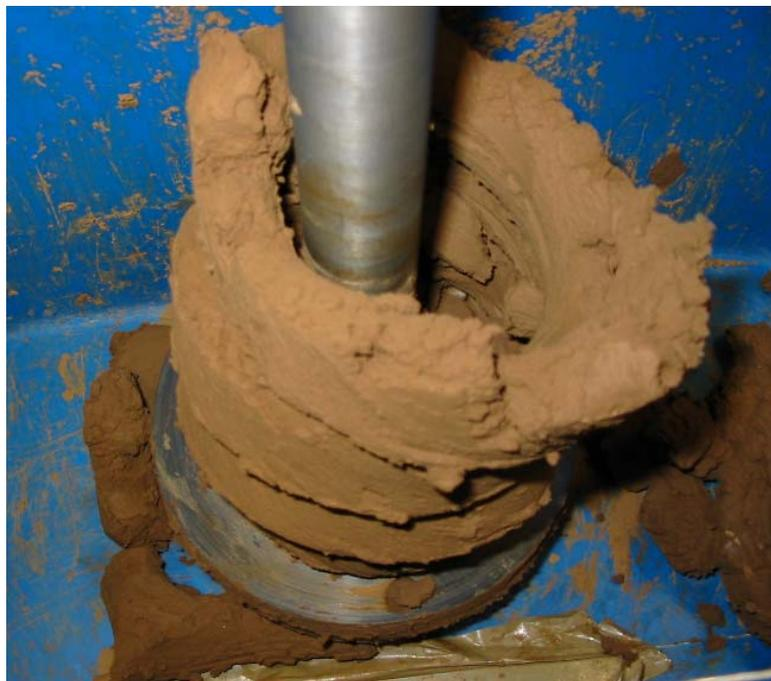
**Abb. 7.16:** Unterschiedliche Förderarten bei Versuchen mit dem MRV Kombination M2, Versuch 081,  $w = 26,5\%$  → *Blockförderung*
