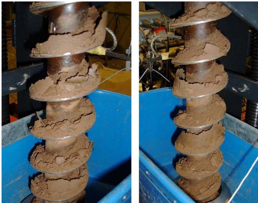
**Abb. 7.7:** Erdstoffkörper auf der Wendel nach dem Versuch (Kombination C2)
