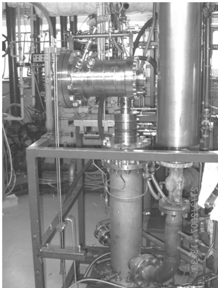
Abbildung 4-9 Versuchsaufbau des Hochdruckverbrennungssystems
