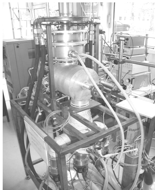
Abbildung 4-1 Versuchsaufbau des Verbrennungssystems zur Untersuchung von Flammenfrequenzgängen für atmosphärische Bedingungen
