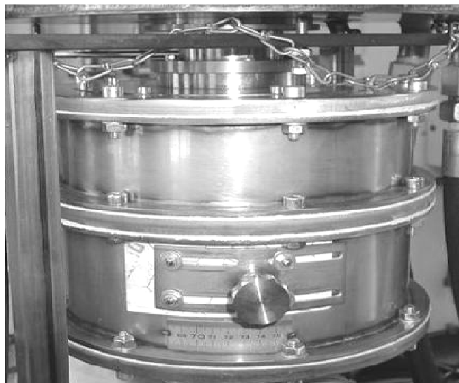
Abbildung 4-2 Pilotierter Vormischdrallbrenner für Untersuchungen unter atmosphärischen Bedingungen [18]
