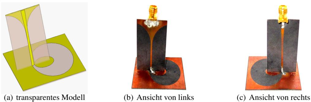
Abbildung 2.20: Prototyp der einzelnen elliptischen Antenne mit einem Speisernetzwerk [AZRZ10]
