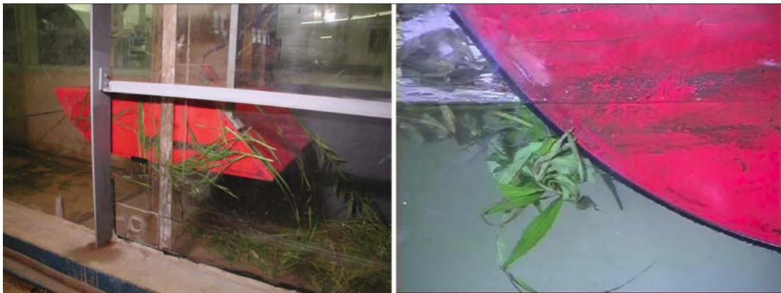
Abbildung 4.56: Gräser im Spalt (links), konstruktive Optimierung mittels Bürste (rechts).
