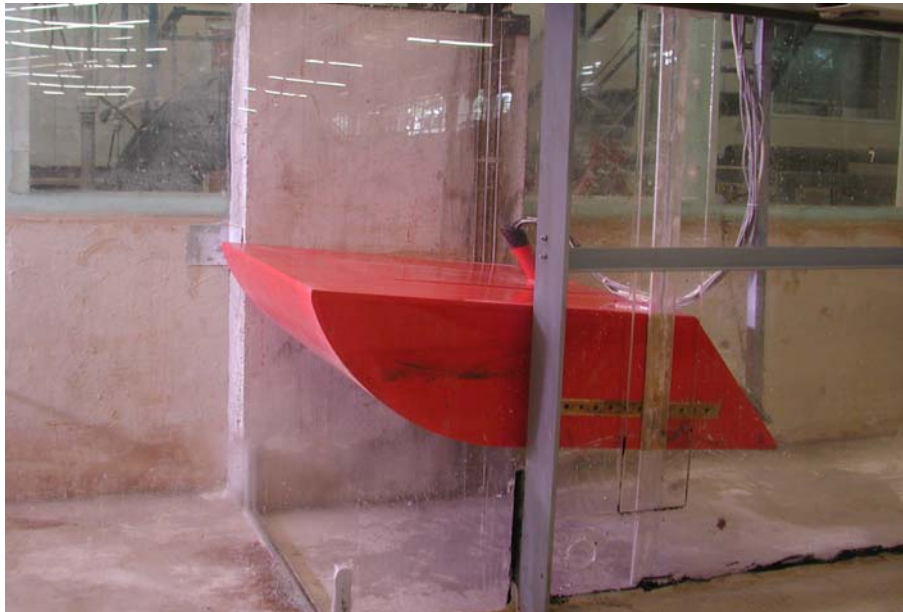
Abbildung 3.5: Detailansicht des untersuchten Prototyp-Klappenkörpers
