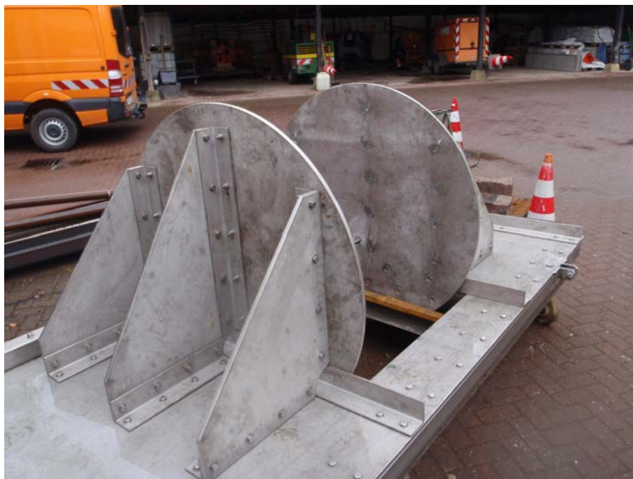
Abbildung D.10: Fertig montiertes Schütz
