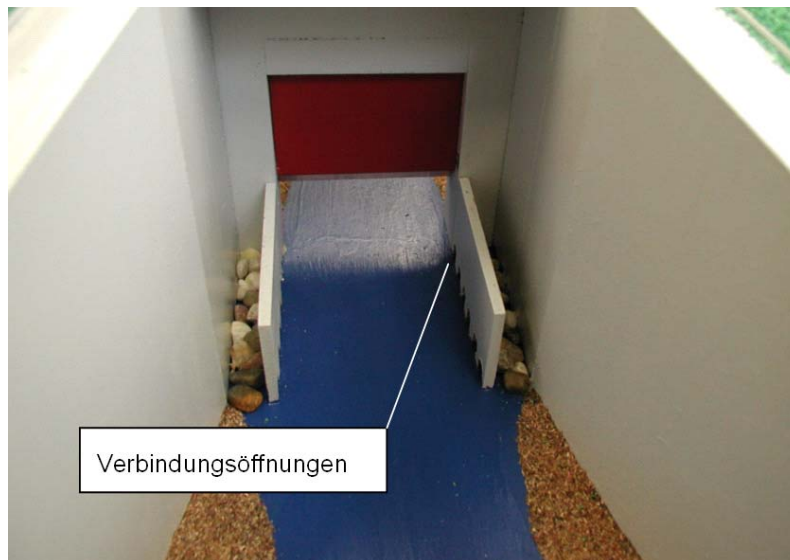
Abbildung 5.14: Blick von Unterstrom auf die seitlichen Sohlstreifen
