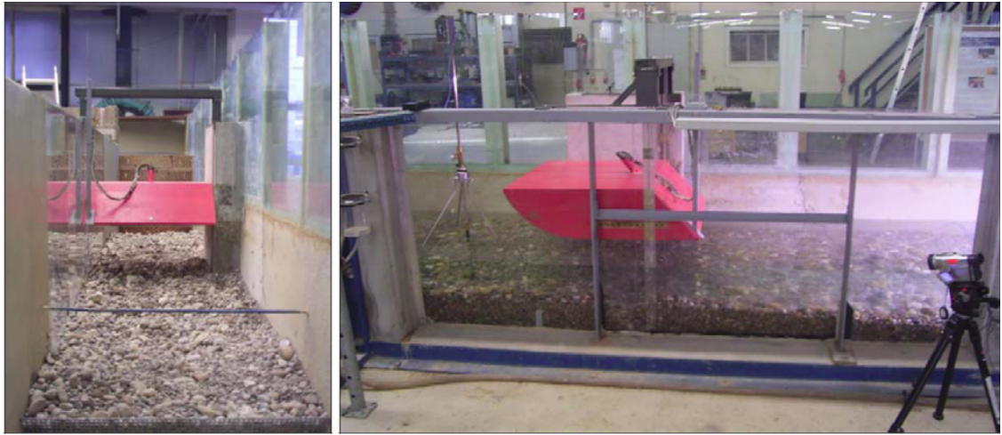
Abbildung 4.59: Versuchseinrichtung mit naturähnlicher Sohlaufage (Mächtigkeit von 20 cm)
