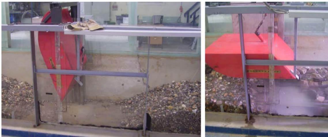
Abbildung 4.60: Versuchseinrichtung mit naturähnlicher Sohlaufage nach Einstau. Links ohne zusätzliche Steinsicherung, rechts mit verklammerter Sohle.
