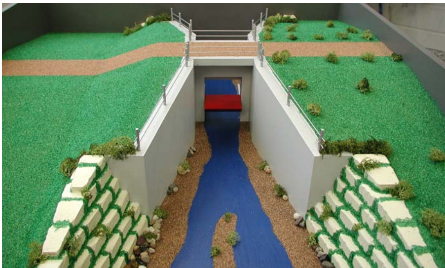
Abbildung 5.2: Anschauungsmodell einer Gesamtanlage mit Schwingklappe
