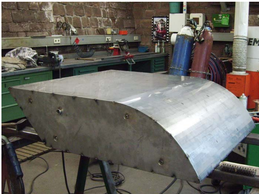
Abbildung D.7: Fixierung der Bepankung im Punktschweißverfahren
