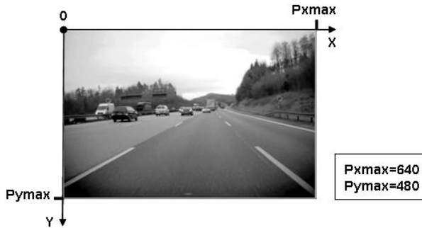
Abbildung 2.10: Koordinatensystem des Monokamerasensors.
