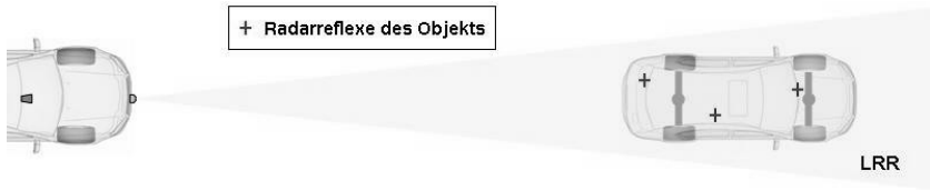
Abbildung 4.13: Typische Radarreflexe eines Fahrzeugs.
