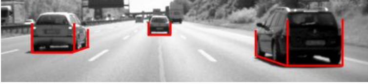
Abbildung 2.7: Kanten-Information eines Fahrzeugs im Bild.
