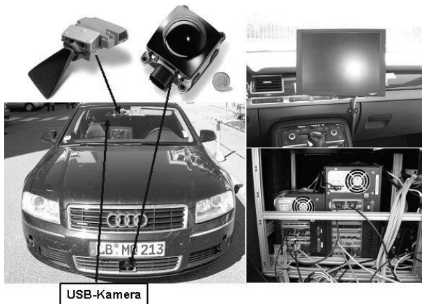
Abbildung 5.1: Aufbau des Versuchsfahrzeugs.
