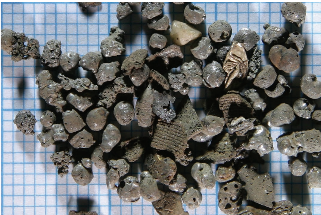
Fig. 4-28. Shape of debris particles, 1,8 - 2,5 mm
