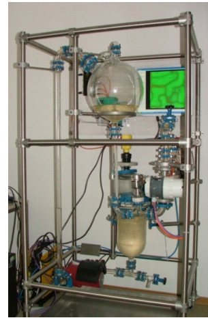
Bild 8: Dargestellt die installierte Versuchsanlage sowie das zu erlernende Sensor/Aktornetzwerk.
