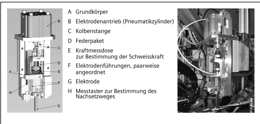
*Abbildung 5: Widerstandsschweißen – neu entwickelter Schweißkopf*
