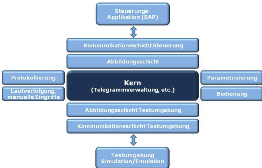
**Abbildung 3:** Struktur einer Schnittstellensoftware zwischen SAP-Steuerungen und Emulationsmodellen
