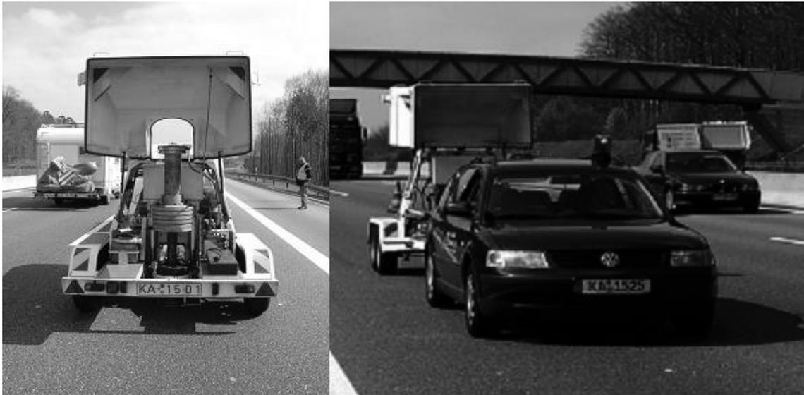
**Abb. B.1:** FWD mit Zugfahrzeug im Messbetrieb
