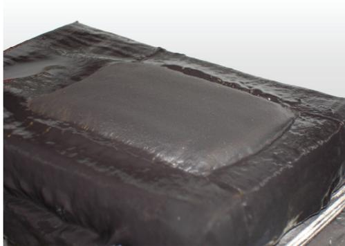
Abb.6.16: Handfilterplatte mit Filterkuchen. Produkt: E8706 ( $c_v=0,08$ ); Filtermedium: UP1,2;  $t_1=120s$ ;  $t_2=60s$ ;  $\Delta p=0,8bar$ ;  $B=0,033T$
