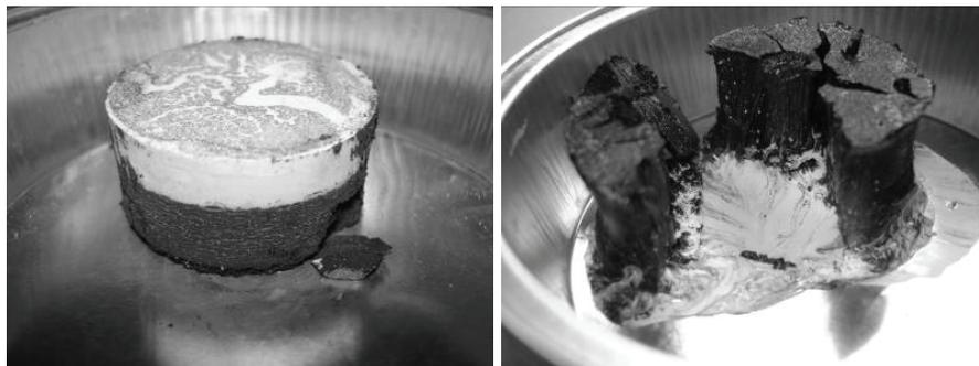
**Abb.8.6:** Filterkuchen aus SF800 und M40-LST in der Kunststoff-Drucknutsche für  $B=0\text{T}$  (links) und  $B=0,11\text{T}$  (rechts). Produkt: SF800, M40-LST ( $c_s=0,1$ ); Filtermedium: UP1,2;  $V=50\text{cm}^3$ ;  $\Delta p=0,8\text{bar}$
