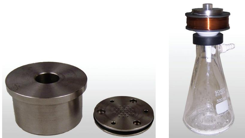
**Abb.4.21: Foto des Büchnertrichteroberteils mit demontierter Filterfläche (links) und der Gesamtanlage (rechts)**
