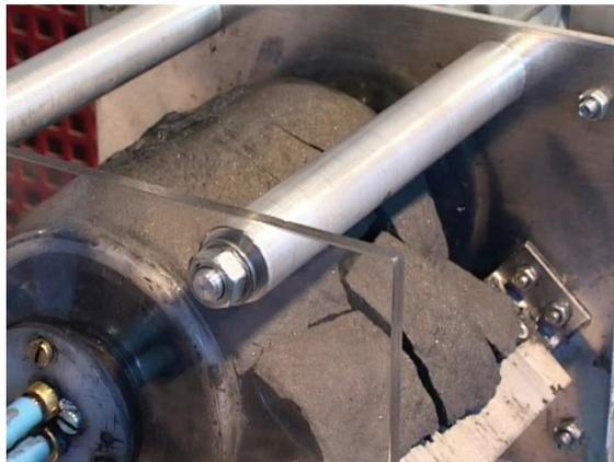
**Abb.6.19: Trommelfilter mit Filterkuchen. Produkt: M40-LST ( $c_v=0,08$ ), Filtermedium: UP1,2;  $n=1\text{min}^{-1}$ ;  $\Delta p=0,7\text{bar}$ ;  $B=0,05\text{T}$**
