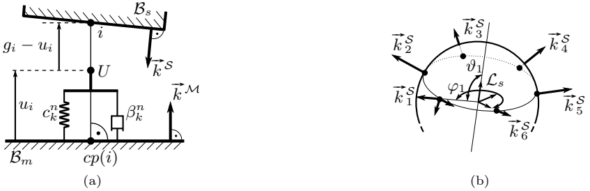
Abbildung 4.8.: (a) Kinematik der WINKLER-Bettung, (b) Äußere Flächeneinheitsnormalen, sechs Slave-Punkte im Modul Kugel-Kugel
