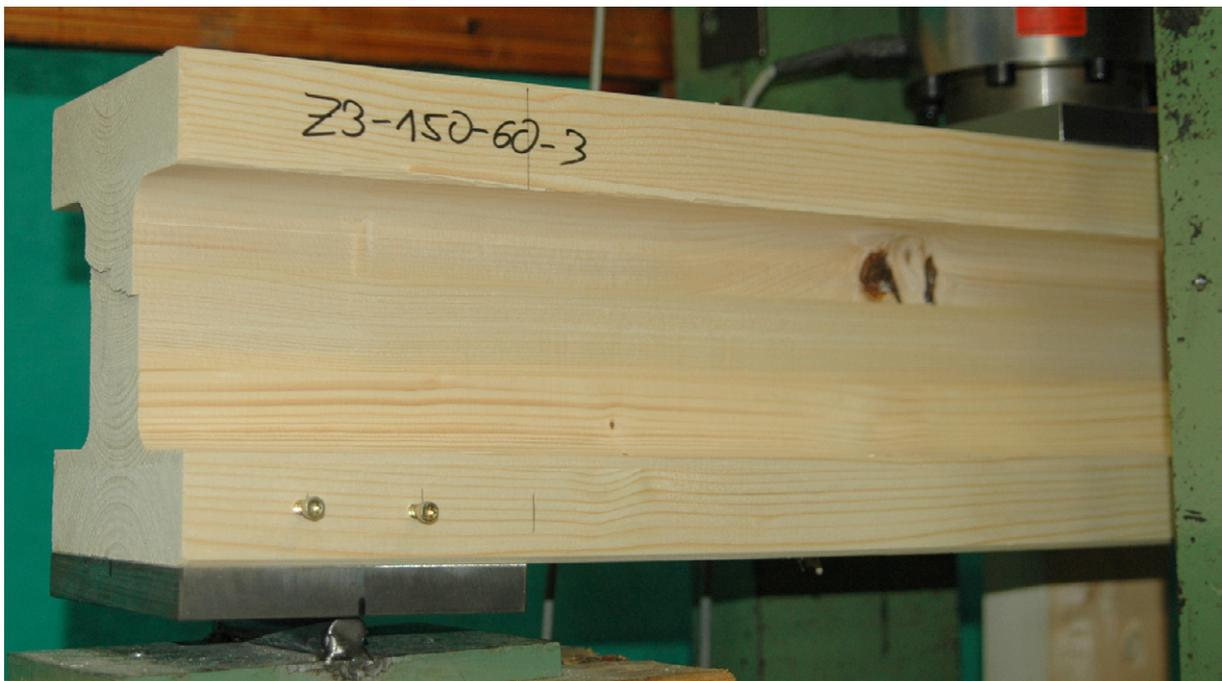
Bild 6-10 Versuch Z3-150-60-3 nach Schubversagen
