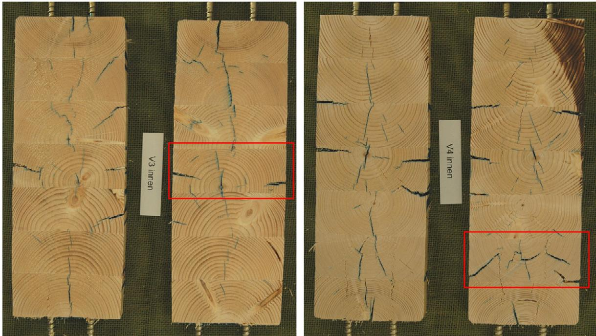
Bild 9-3 Rissbilder der verstärkten Prüfkörper 3 (li.) und 4 (re.)
