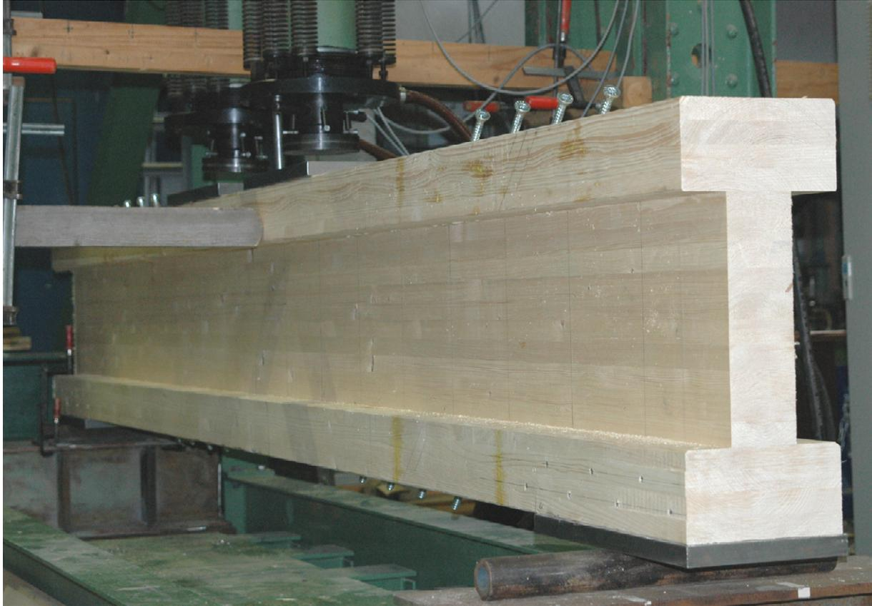
Bild 6-5 Mit Gewindestangen schubverstärkter Träger
