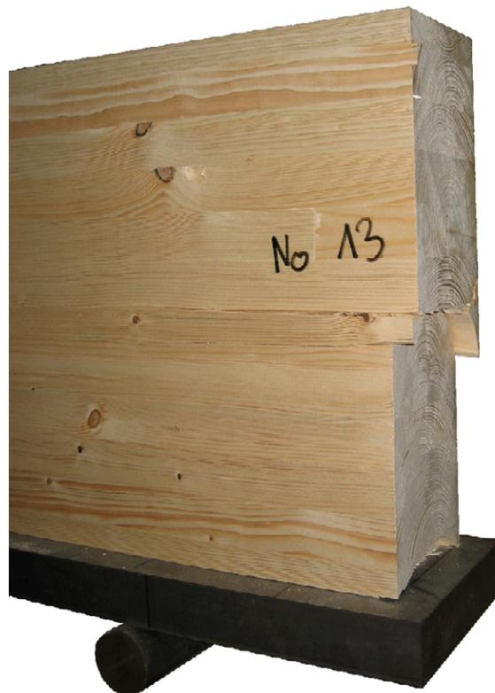
Bild 2-1 Schubversatz nach Schubversagen
