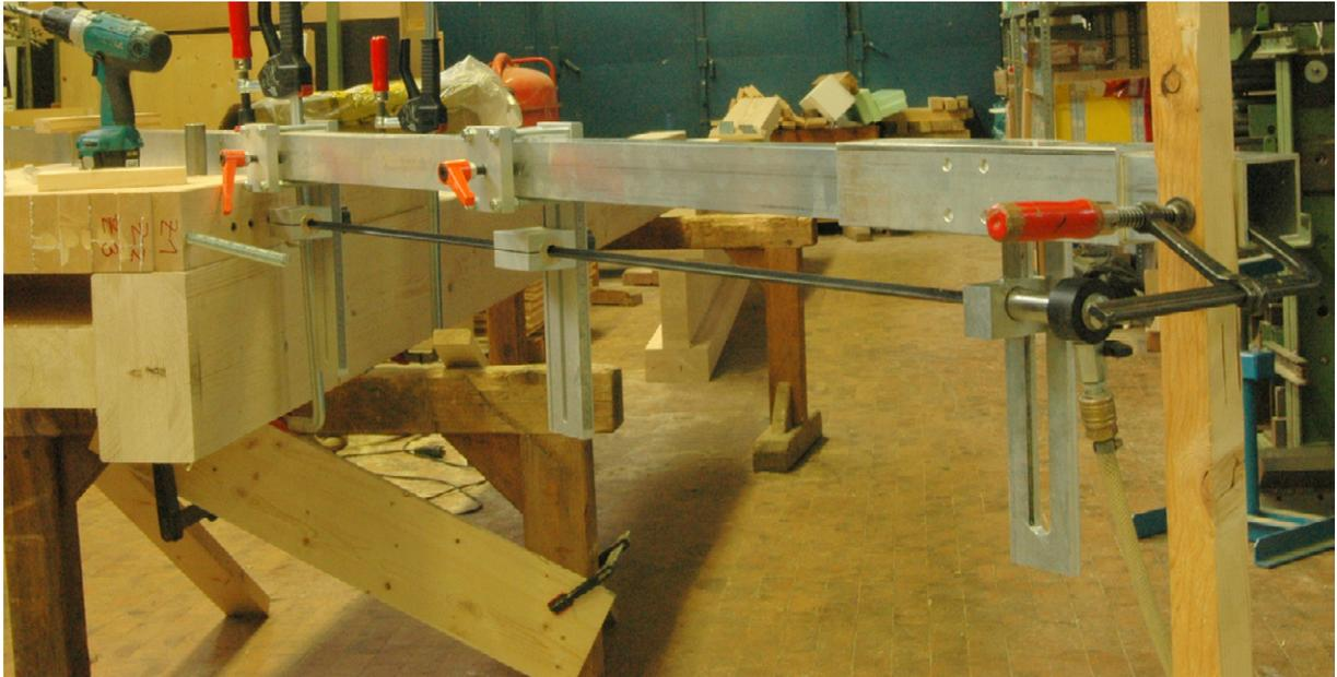
Bild 6-3 Modifiziertes Bohrsystem
