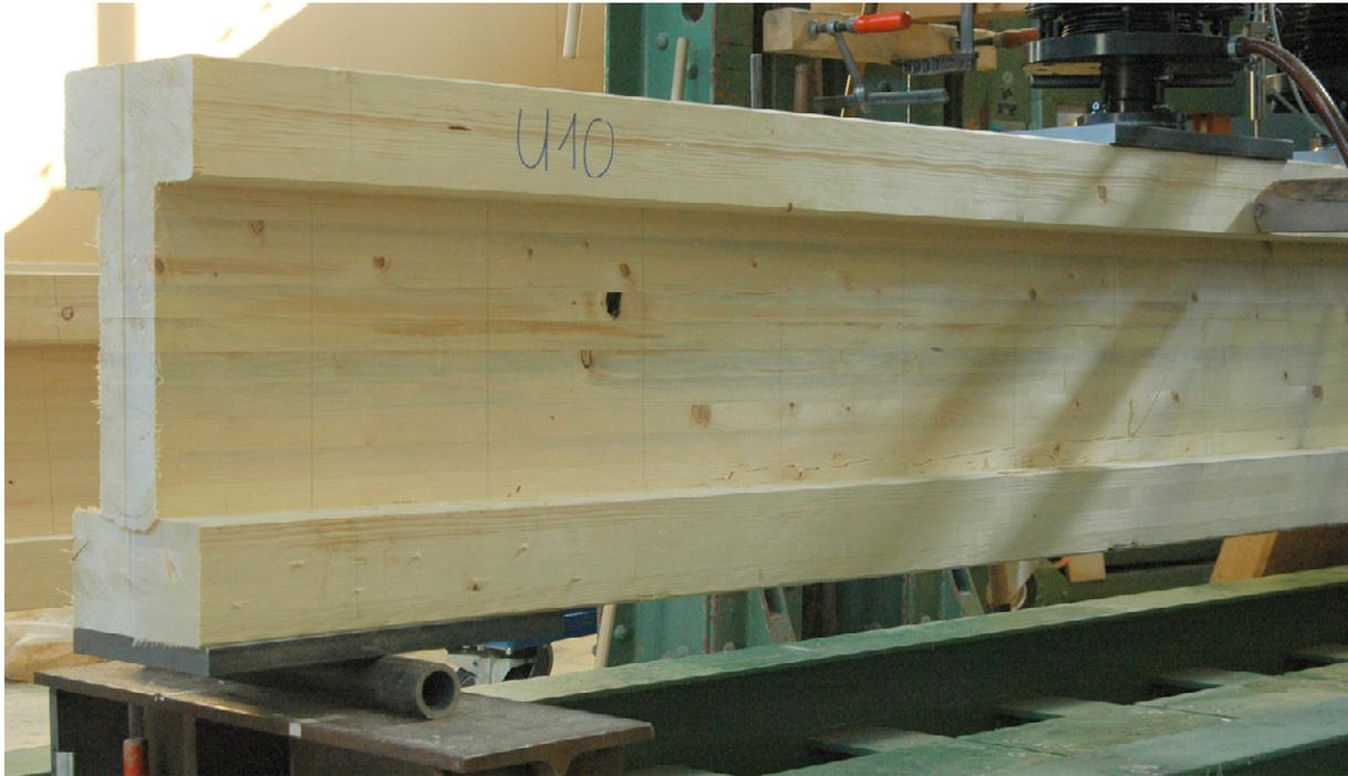
Bild 6-7 Versuch U10 nach Schubversagen
