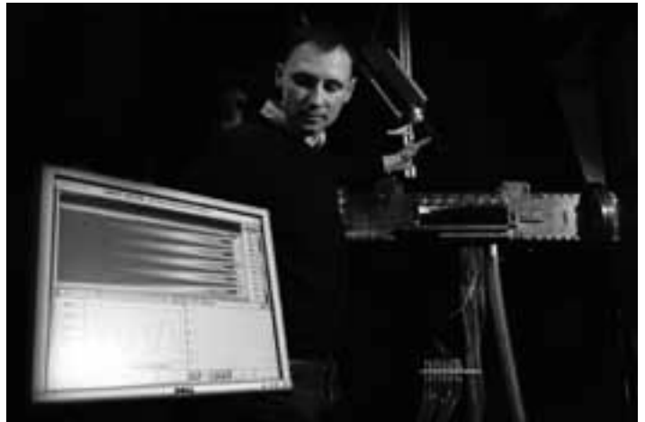
Untersuchung der Filmkühlung einer transsonischen Turbinenstufe an einem generischen Modell, Institut für Thermische Strömungsmaschinen
