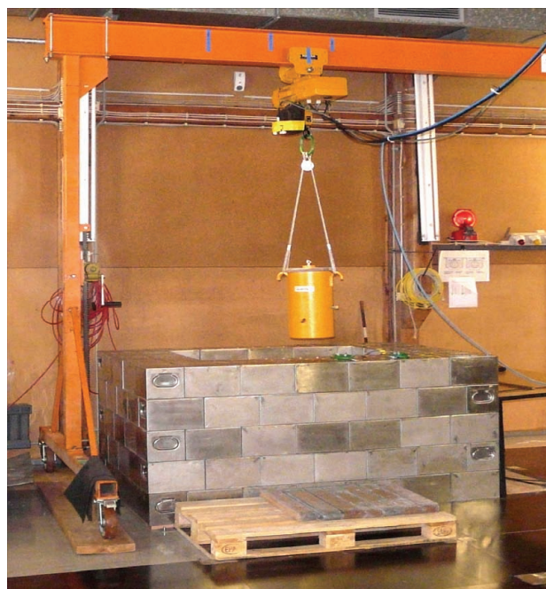
Abb. 5-5: Kran, Abschirmflasche und Abschirmbunker
