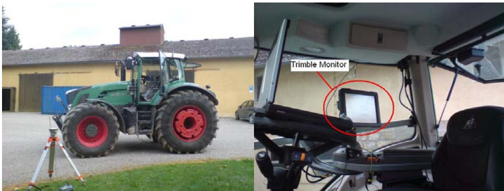
Bild 1: Fendt 936 Vario Traktor und seine Kabine mit Trimble Navigationsmonitor
