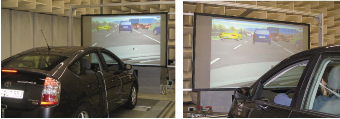
Bild 7-13: Vehicle-in-the-loop-Aufbau: Fahrstrategie für Hybridfahrzeuge
