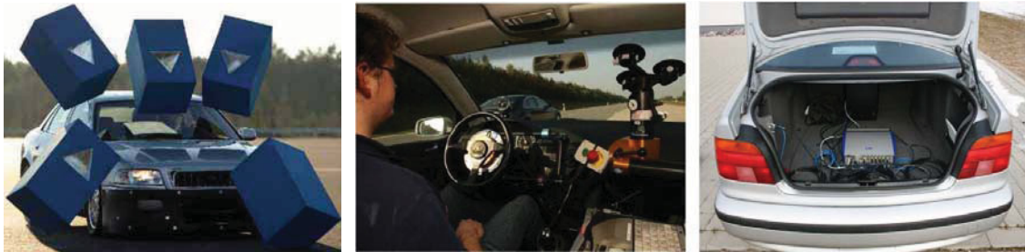
Bild 2-30: Fahrversuch (links: radarsensitive Schaumstoffwürfel zur Nachbildung von stehenden Fahrzeugen im modernen Fahrversuch 152 , Mitte: ACC-Abstimmung in realer Umgebung 153 , rechts: Fahrbarkeitsanalyse mit AVL DRIVE)
