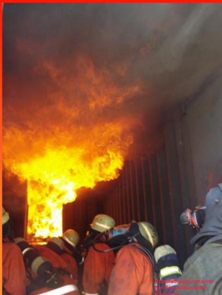
Rollover in der Brandübungsanlage der Feuerwehr Karlsruhe
