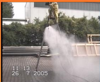
Sprühkopf mit 4 Düsen – 135 bar Ablenkung durch Wind im Freien
