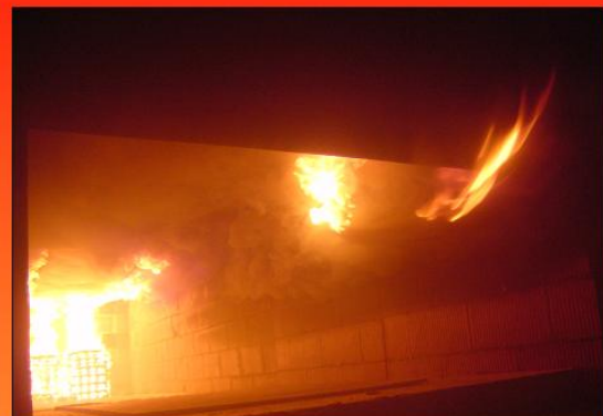
Rollover während eines Brandversuches an einem Industrieleichtdach an der FFB
