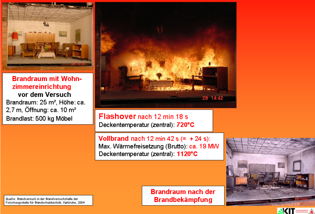
Bild 8: Flashover bei einem Wohnzimmerbrand (FFB)
